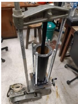
รูปที่ 3-2 บดอัดทรายตัวอย่างใส่แบบจำลอง
